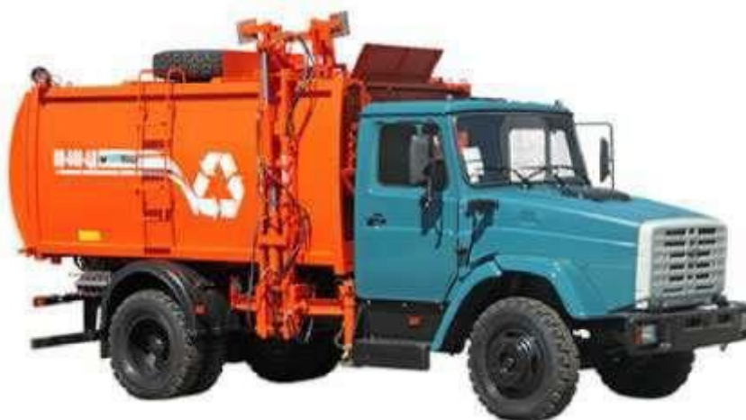
Рисунок 4 Мусоровоз КО 440-4 на шасси Зил-433362
